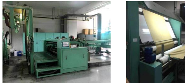
ภาพที่ 6 เครื่องบีบอัดสารตกแต่งสำเร็จ
